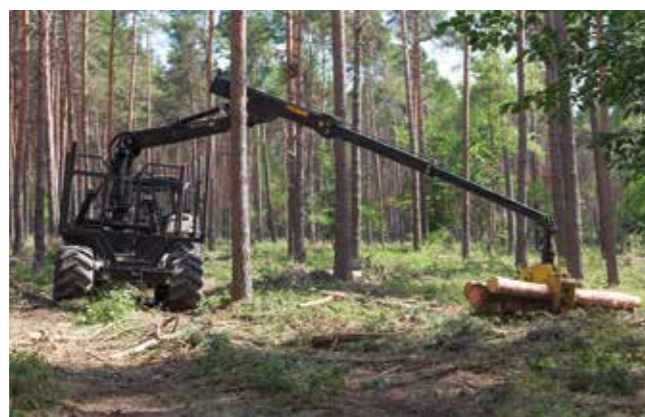
Auch unbeladen und bei maximaler Kran-Reichweite von 10 m steht der RW-HS-19/21 sicher im Bestand.
